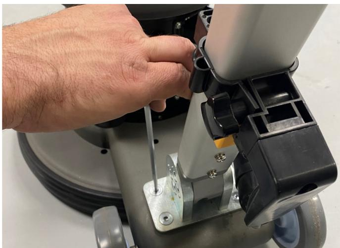
1. Installer l'ensemble du timon sur la tête de lavage en serrant les 4 boulons (M8 x 25).
