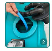
Rincer le réservoir de récupération au jet d'eau puis replacer le bouchon du tuyau de vidange
