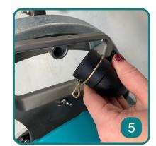
Débrancher le tuyau d'aspiration pour le nettoyage de l'orifice du suceur
