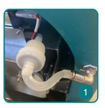
Si l'eau ne coule pas, remplacer le filtre
