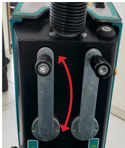
1. Sélectionner l'interrupteur vers l'avant (marche AV), abaisser le levier d'actionnement du système d'aspiration pour activer le moteur d'aspiration (lorsque le levier d'actionnement du système d'aspiration est abaissé, la machine peut seulement avancer, mais pas reculer.)
