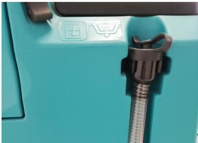
1. Vider le réservoir de solution en ouvrant le tuyau de vidange.
