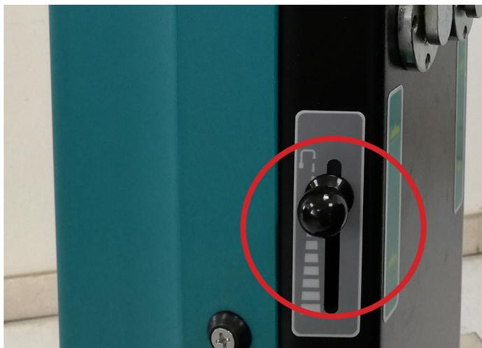
Déplacer le levier de réglage du débit d'eau (descendre pour augmenter le débit d'eau ou monter pour le réduire.)
