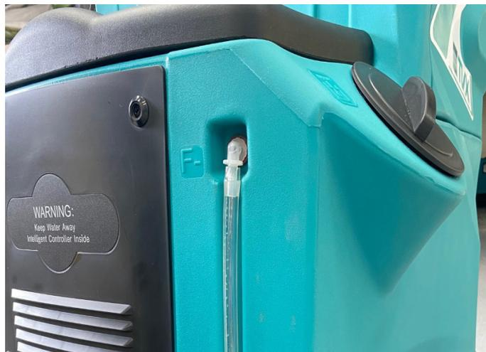
3. Vérifier le niveau d'eau à l'aide de l'indicateur de niveau d'eau.
