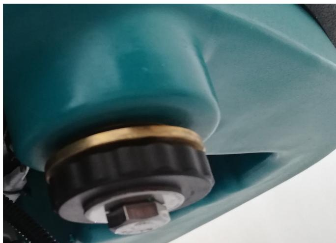
1. Vider le réservoir de solution en dévissant la vidange de cuve
