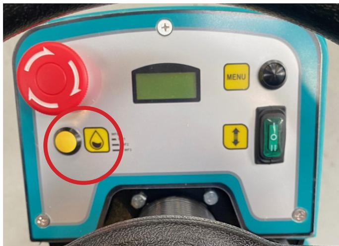
Appuyer sur le bouton de réglage du débit d'eau. (WF0 : fermé / WF3 : entièrement ouvert, avec le plus grand volume d'eau.)
