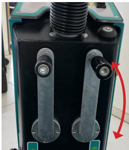
1. Sélectionner l'interrupteur vers l'avant ( marche AV) ou vers l'arrière (marche AR), abaisser le levier d'actionnement de la (les) brosse(s) pour activer le (les) moteur(s) de brosse(s).
