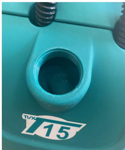
1. Retirer le bouchon du réservoir de solution.
